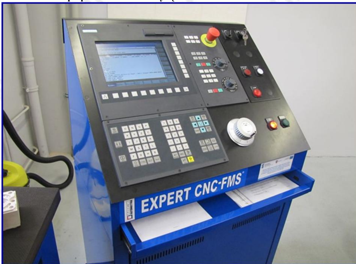
Pracownia CNC pulpitu sterowania maszyną CNC – sterowanie SIEMENS SIMATIC 802D
